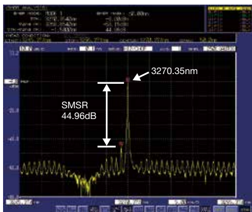
针对3270nm DFB-LD的测量实例 (分辨率: 0.1nm, 跨度: 50nm)
