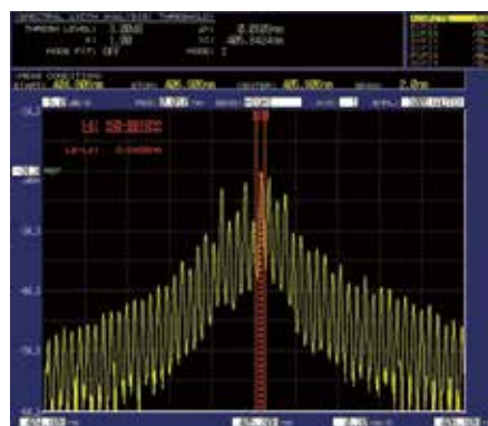
405nm FP-LD测量(分辨率设置: 0.01nm)
